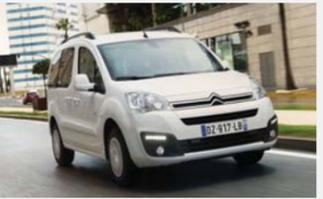
□ كشفت شركة ستروين النقاب عن سيارتها «ميلتي سبايس» الكهربائية، والتي تنتمي إلى فئة الكومبي المرتفعة. وأوضحت الشركة الفرنسية أن سيارتها الجديدة ينبض بداخلها محرك كهربائي بقوة 49 كيلووات/200 نيوتن متر لعزم الدوران الأقصى، وتتولى تغذيته بالتيار اللازم بطارية ليثيوم أيون سعة 22.5 كيلووات/س، تصل بفضلها السيارة إلى السرعة القصوى 170 كلم/س.
