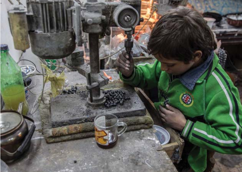
عملية ثقب حبات السبج بإحدى الورشات في شارع المعز بالقاهرة
