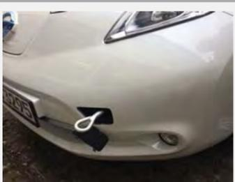
أشارت الهيئة الألمانية للفحص الفني إلى أن السيارات الكهربائية أو الموديلات الهجينة أو السيارة، التي تجمع بين محرك الاحتراق الداخلي ومحرك كهربائي، لا يمكن قطرها إطلاقا أو يمكن قطرها بصعوبة بواسطة قضيب أو حبل القطر. لكن خبراء الهيئة قالوا إنه يمكن قطر السيارات الكهربائية فقط عندما يتم فصل المحرك عن العجلات المدفوعة، علاوة على أن هناك بعض السيارات المزودة بناقل حركة أوتوماتيكي ونظام دفع رباعي قد تتعرض للضرر في حالة قطرها.
