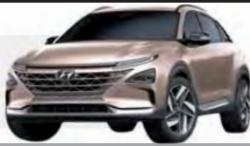
هيونداي الكورية الجنوبية أطلقت نسخة كهربائية جديدة من أيقونتها نيكسو فئة الموديلات الرياضية متعددة الأغراض، والتي تعتمد على تقنية خلايا الوقود وتستمد التيار من خزان للهيدروجين ليلبغ مدى سيرها 600 كلم.
